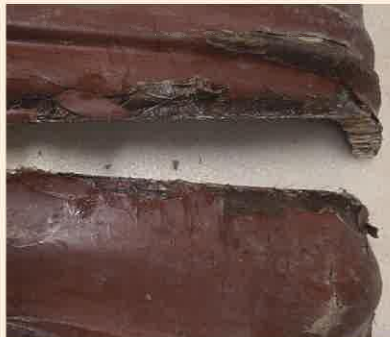
[図136]裳裾左側部材 矧ぎ目 白濁した接着剤
