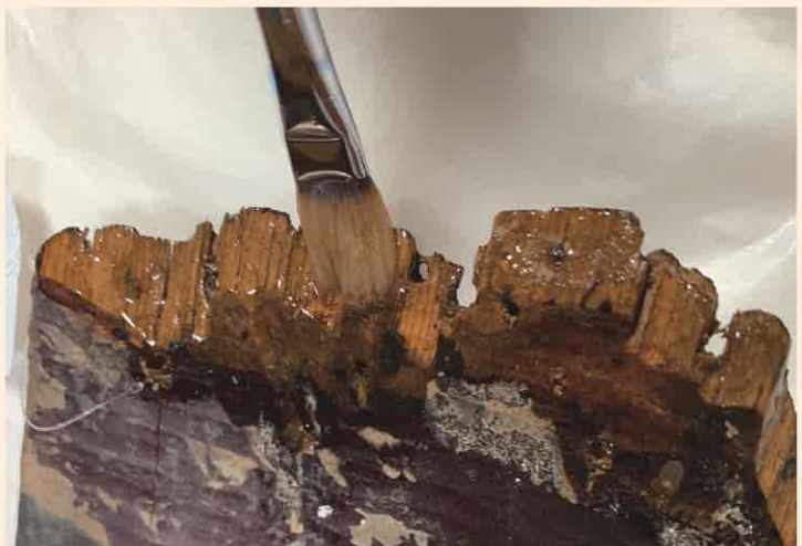
〔図76〕含浸強化処置中
