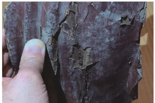
[図42]裳裾左側部材 剝落
