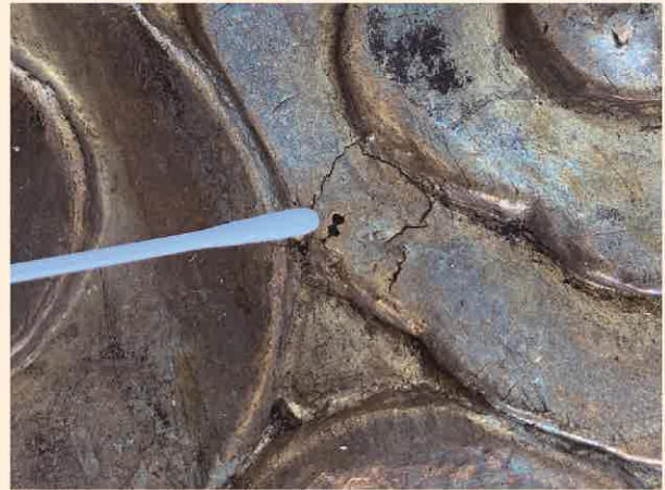
〔図169〕エポキシ樹脂充填前の虫穴
